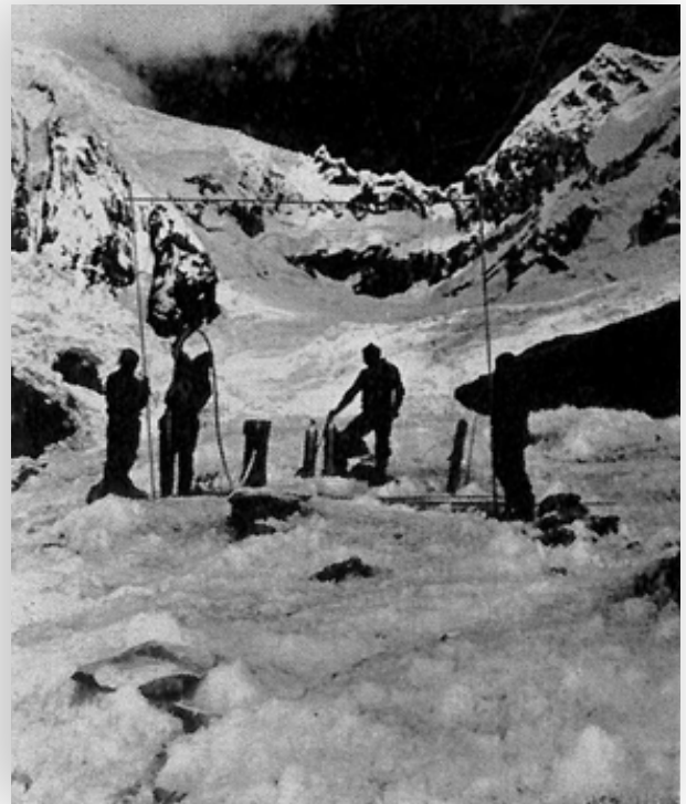
Perforaciones térmicas en el glaciar del Pucahirca con las estacas de ablación.
